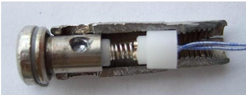
Le réglage de la course doit être tel que le contact électrique ne doit se produire que si la distance entre l'arrière de la tête et le sommet de l'embase est inférieur à 0,5mm. Ceci se fait à l'aide d'une « pige » (lame de métal d'épaisseur calibrée de 0,5mm) - voir la photo ci-après.
